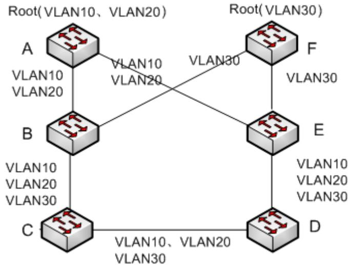
Figure 217 DRP-IEC62439-VLAN-Based
